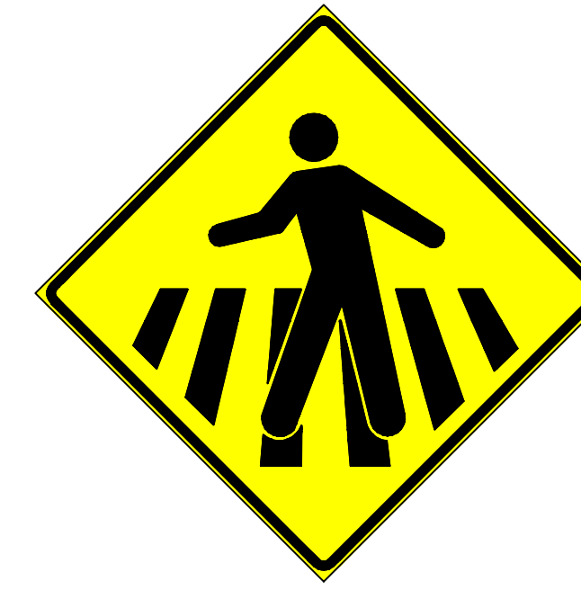
A-32b PASSAGEM SINALIZADA DE PEDESTRES
